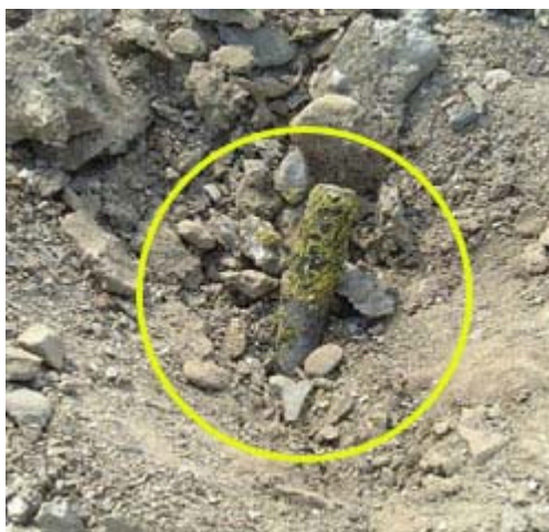
Figura 4 - Dardo a uranio impoverito inesplosa, potenziale causa di contaminazione ambientale (Fonte: CISAM)
