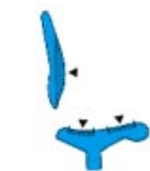
Piano del sedile e schienale ben profilati: supporto lombare; spessa imbottitura semirigida; rivestimento traspirante.
